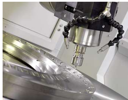
Bild 3: Die Schwenkachse sorgt dafür, dass die Spindel mit dem Fräswerkzeug immer in einem Winkel von 90° zur wechselnd konvexen und konkaven Oberfläche steht.
