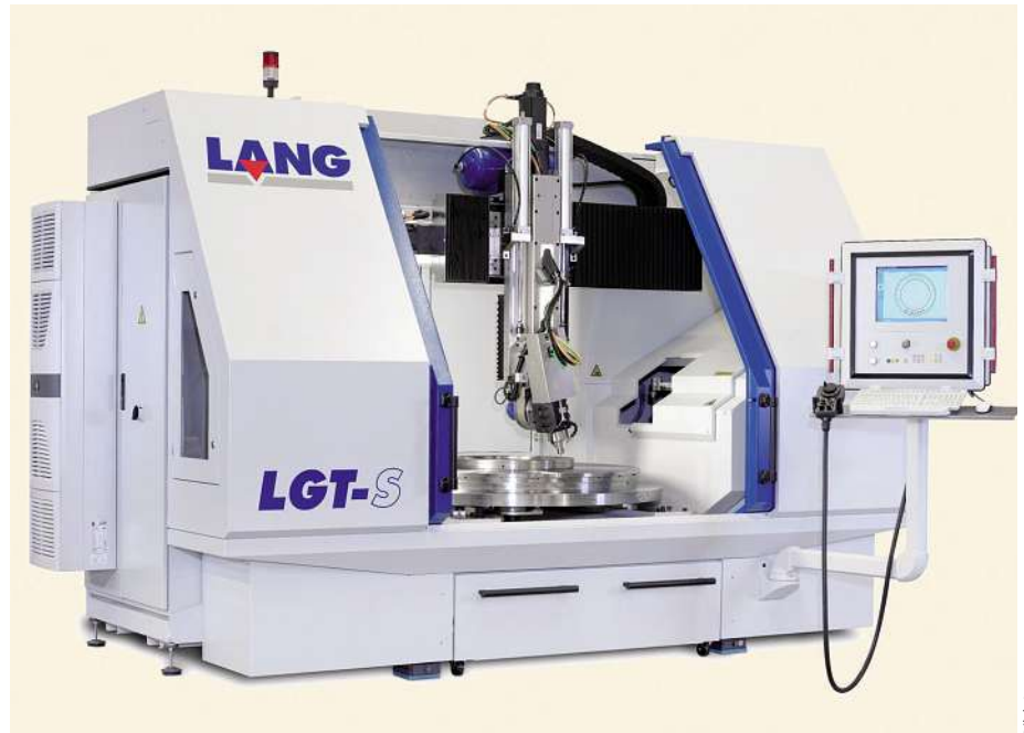
Bild 2: Mit der LGT-S werden Seitenwandformen bis zu einem Werkstückdurchmesser von 1200 mm bearbeitet. Es sind verschiedene Schriften und 3D-Tiefenstrukturen möglich.
