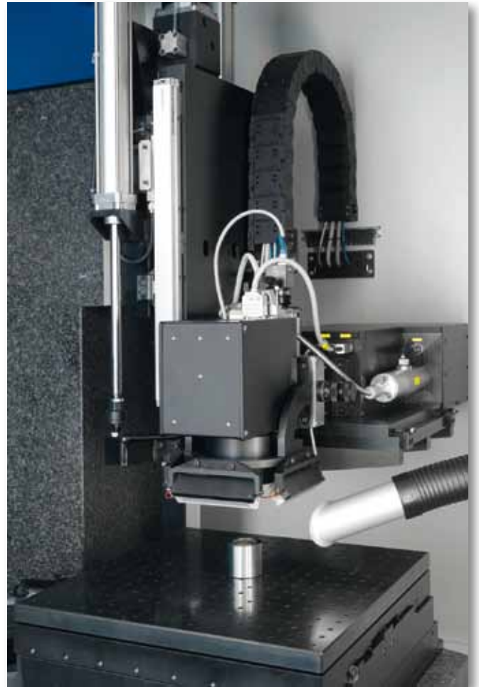
Abb.5: Lochrastertisch ermöglicht unterschiedliche Aufspannmöglichkeiten
