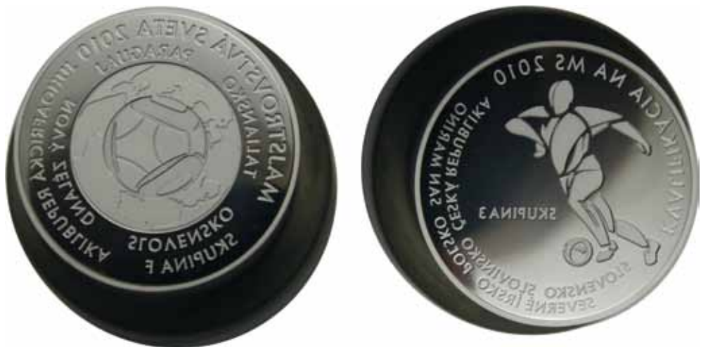
Abb.6: Frosting der Oberflächen von Münzprägestempeln
